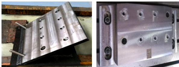
图7 提制两套专用磁极压板铣胎
