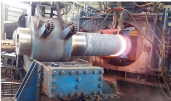
图 2 G115 钢加热弯制图
