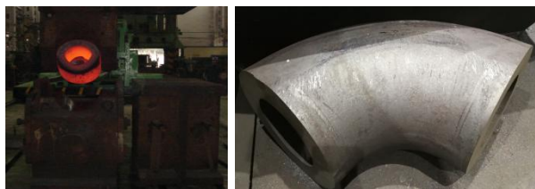
图 7 G115 弯头压制及成品
